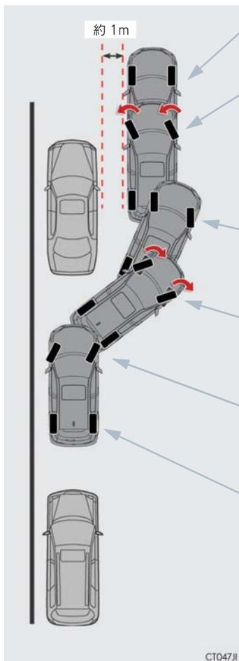
道路と平行で、駐車している車との間隔が約1mの位置で止まる。「駐車する」：手順 1
