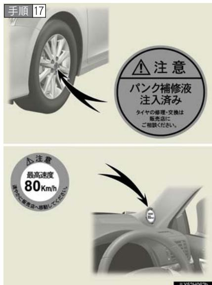
応急修理キットを収納し、付属のラベル2枚を図のようにそれぞれ貼り付ける
