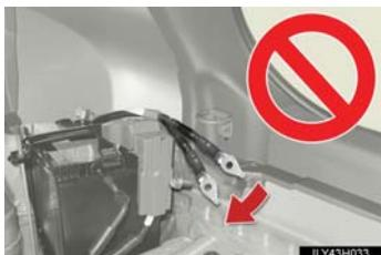
ボデーに接続された補機バッテリーのマイナス端子をはずさないでください。誤ってはずすとプラス端子と接触し、重大な傷害におよぶか、最悪の場合死亡につながるおそれがあります。
