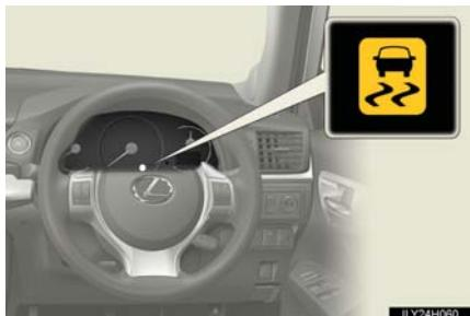
車両が横すべりしそうになったとき、駆動輪が空転したときは、VSC・TRCの作動を表示するためにスリップ表示灯が点滅します。
