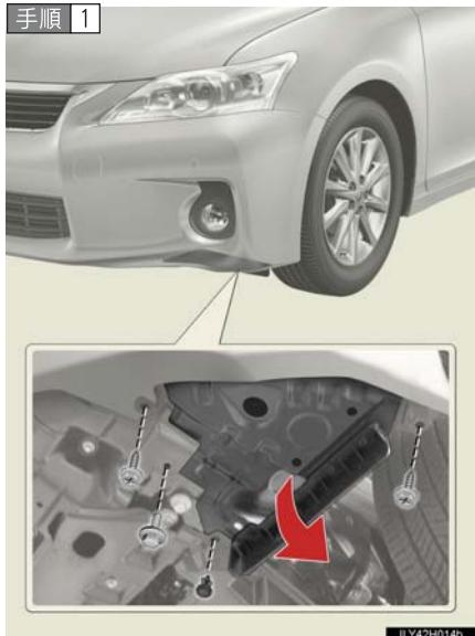
フォグライト下側のカバーの固定スクリュー（2本）・固定ボルト（1本）とクリップ（1本）を取りはずし、カバーを引き下げてめくる
