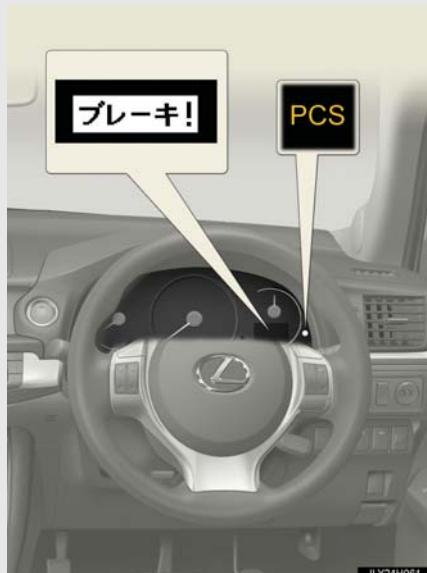
衝突の可能性が高いと検知したとき、“ピピピ……”とブザー音が鳴り、PCS 警告灯が点滅し、マルチインフォメーションディスプレイに衝突警告表示を出し、回避操作をうながします。
