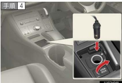
応急修理キットの電源プラグをアクセサリーソケットに挿し込む
