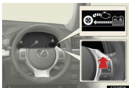
DISP スイッチを押してエネルギー モニターを表示させる
