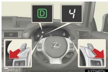
シフトポジションがDで走行中、パドルシフトを操作することにより任意のシフトレンジを選択することができます。この場合、シフトレンジ表示灯に選択されているシフトレンジが表示されます。
