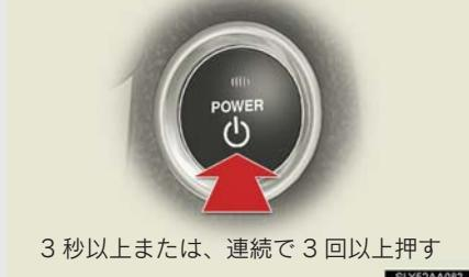
“パワー”スイッチを 3 秒以上押し続けるか、素早く連続で 3 回以上押してハイブリッドシステムを停止する
