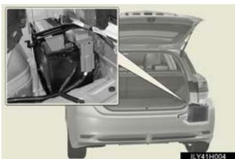
この車の補機バッテリーは、ラゲージルーム（運転席側）のカバー内にあり、エンジンルームには搭載されていません。（補機バッテリーはメンテナンスフリータイプのため、バッテリー液量等の点検は不要です）
