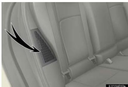
リヤシート横（運転席側）部には、駆動用電池冷却用の吸入口があります。吸入口をふさいだりすると、駆動用電池の過熱や出力低下の原因になります。
