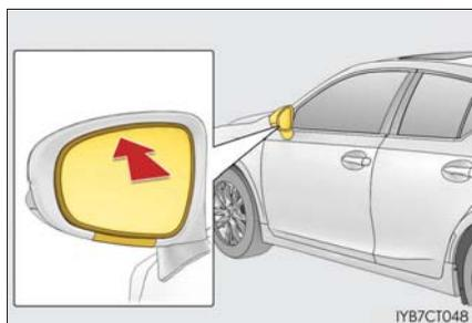
**2** 保護テープを巻いたマイナスドライバー（2本）の先端を挿し込んで、ミラー裏側のツメ（4か所）をはずす
