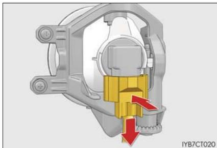
**3** 電球を取りはずす
