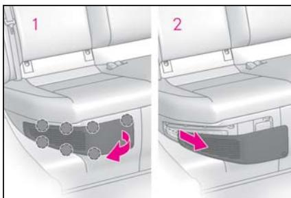
1 吸入口カバーを手前に引いて、図で示す7ヶ所のツメを右端からはずす
