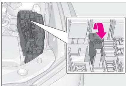
**4 赤色のブースターケーブルを自車の救援用端子**A**につなぎ、もう一方の端を救援車の補機バッテリーの十端子**B**につなぐ。その後、黒色のブースターケーブルを救援車の補機バッテリーの一端子**C**につなぎ、もう一方の端を、未塗装の金属部**D**につなぐ**
