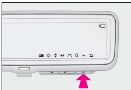
**2 選択スイッチの ➤ または ➥ を押して設定変更したい項目にカーソルを合わせて、メニュー／決定スイッチを押す**
