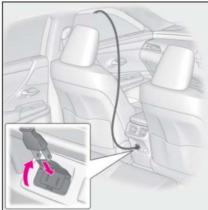
電気製品の接続されていることがわかるように助手席の窓から延長コードを出すことをおすすめします。その場合は、図で示すように接続されたコードにたるみをもたせ、異常な張りが発生しないようしてください。
