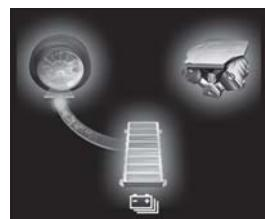
ガソリンと電気の両方のエネルギーで走行しているとき
