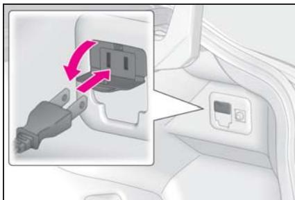
アース線のある電気製品を使用するときは、トランク内コンセントを使用し、アース線をアース端子に接続してください。
