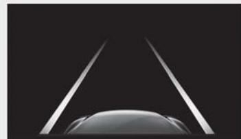
システムが白（黄）線または走路※を認識していることを示しています。車両が車線から逸脱した場合、逸脱している側の白線表示が橙色で点滅します。
