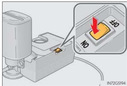
**12** 空気圧が指定空気圧になるまで充填する
