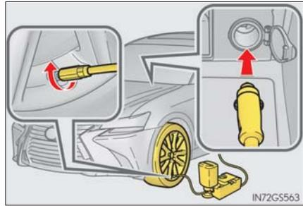
**19** コンプレッサーのスイッチをONにして数秒間経過後、スイッチをOFFにして空気圧を確認する
