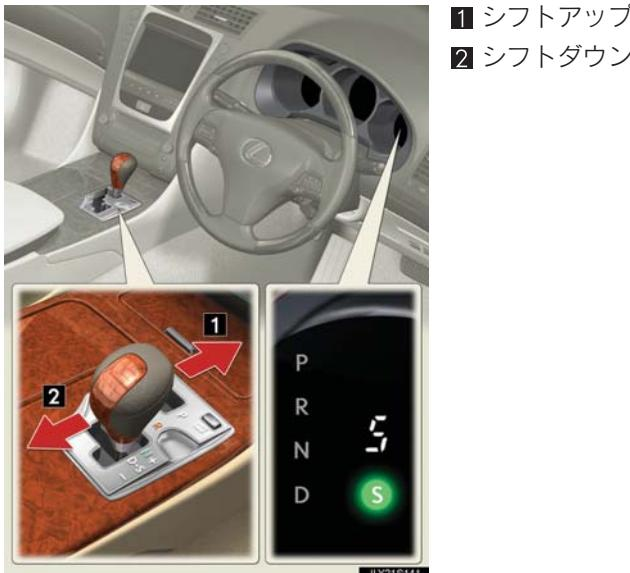
S ポジションへ操作したときの初期段数は「5」に設定されます。また、「6」を選択しているときは、D ポジションと同じ制御になります。
