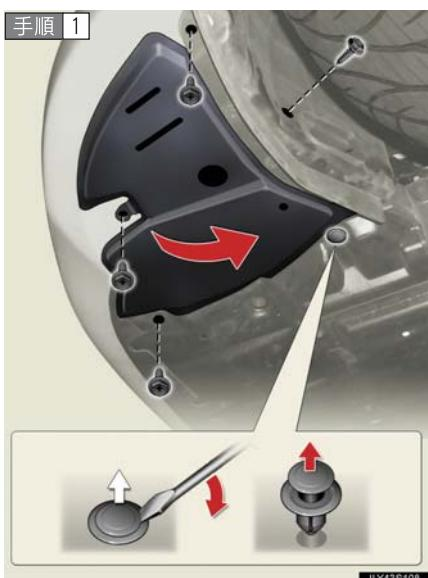
フェンダーライナー側の固定ボルトとフォグライト下側のカバーの固定ボルト、クリップをはずし、カバーをめくる
