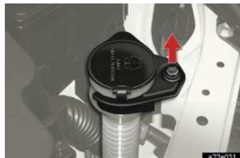
ウォッシャー液補給口の固定ボルトをはずし、
