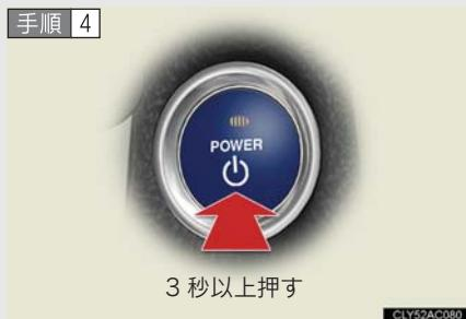
“パワー”スイッチを 3 秒以上押し続けてハイブリッドシステムを停止する
