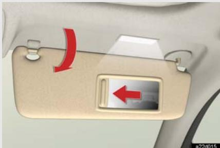
サンバイザーを下ろし、カバーをスライドして開けます。
