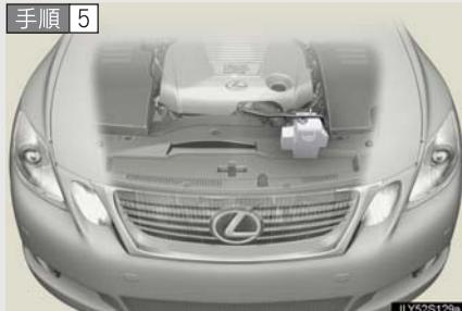
ハイブリッドシステムが十分に冷えてから、冷却水の量やラジエーターコア部（放熱部）の冷却水漏れを点検する
