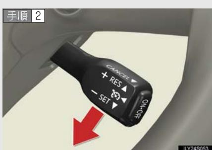
希望の速度まで加速／減速し、レバーを下げる設定する
