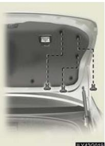
トランクを開け、トランクグリップを取りはずし、トランクパネルカバーのクリップを取りはずす
