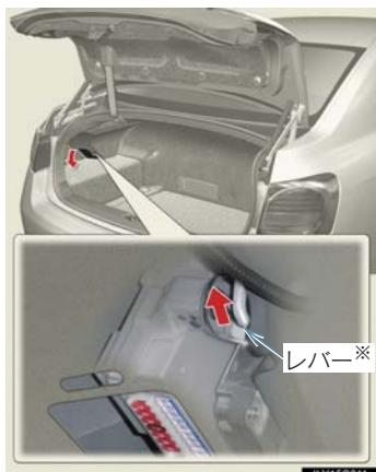
車内のスイッチを押しても給油口が開かないときは、トランク内のレバーを引きます。
