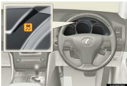
車両が横すべりしそうになったとき、後輪が空転したとき、坂道発進をしたときは、S-VSC・TRC・ヒルスタートアシストコントロールの作動を表示するためにスリップ表示灯が点滅します。
