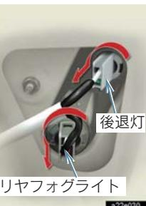
トランクパネルカバーの一部をはずし、ソケットを取りはずす
