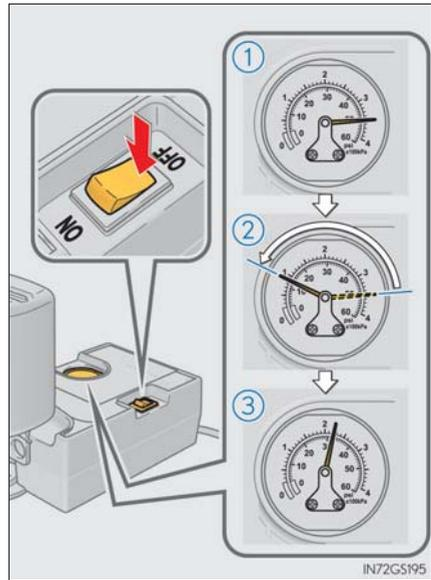
**13** コンプレッサーのスイッチが OFF であることを確認した上で、アクセサリソケットから電源プラグを抜き、タイヤのバルブから応急修理キットのホースを取りはずす
