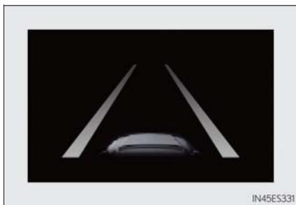
システムが白（黄）線を認識していることを示しています。車両が車線から逸脱した場合、逸脱している側の白線表示が橙色で点滅します。
