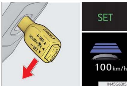
車速が約 50km/h 未満、かつ先行車がいる状態でレバーを操作したときは、設定速度が約 50km/h にセットされます。
