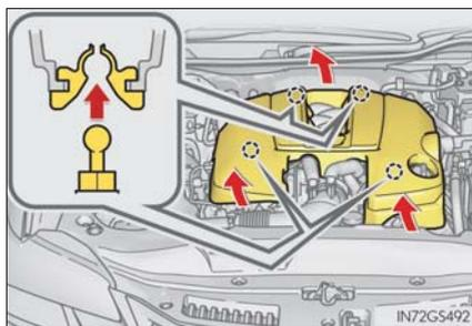
前方のクリップをはずしてから、後方を持ち上げてはずす
