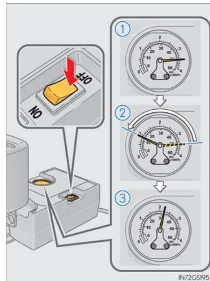
**13** コンプレッサーのスイッチが OFF であることを確認した上で、アクセサリーソケットから電源プラグを抜き、タイヤのバルブから応急修理キットのホースを取りはずす
