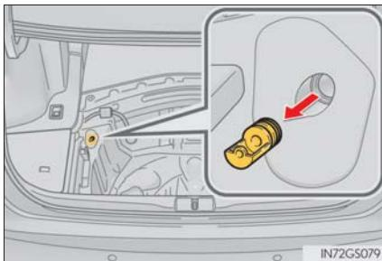
**4 工具を挿し込み、強く押しあてながら左へ止まるまでまわす**
