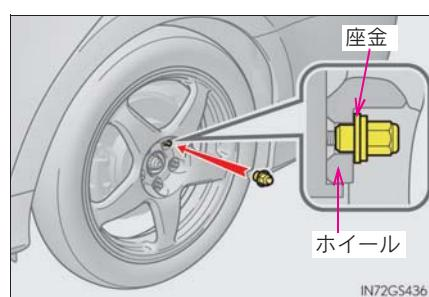
**3** 車体を下げる
