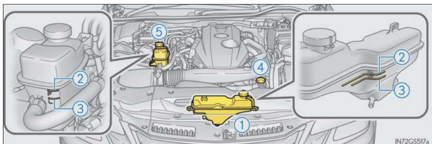
**5** 冷却水が不足している場合は、冷却水を補給する
