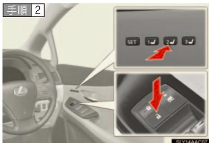
1 ～ 3 のうち連動させたいボタンを押してポジションを呼び出す。呼び出したら、そのボタンを押しながら、ドアロックスイッチ（運転席側）の施錠側または解錠側をブザーが鳴るまで押す。
