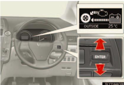
“ENTER” スイッチを上下に操作してエネルギーモニターを表示させる
