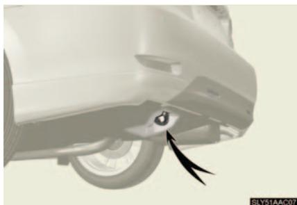
リアの固縛用フックを緊急用フックとしても使用できます。雪の吹きだまりなどでスタックして走行できなくなったときに緊急的に他車に引っ張り出してもらうときに使用するものです。他車をけん引することはできません。
