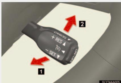
希望の速度まで加速／減速し、レバーを下げて設定する
