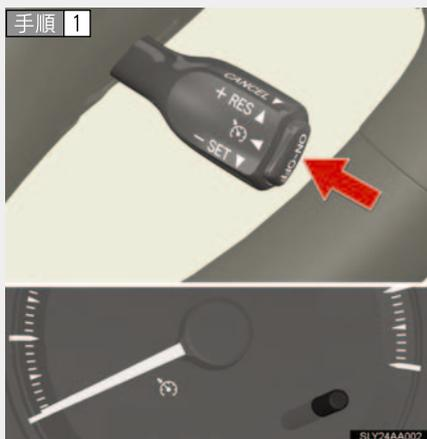
“ON-OFF” スイッチを押して、システムを ON にする
