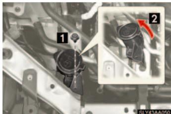
ウォッシャー液補給口の固定クリップをはずし、補給口の位置を移動させると、交換しやすくなります。
