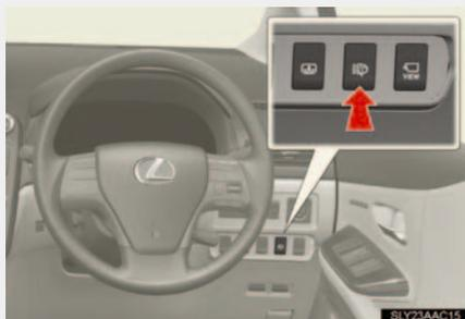
スイッチを押してヘッドライトを洗浄する
