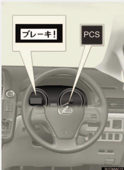
衝突の可能性があると検知したとき、“ピーピーピー”とブザー音が鳴り、PCS警告灯が点滅し、マルチインフォメーションディスプレイに衝突警告表示を出し、回避操作をうながします。
