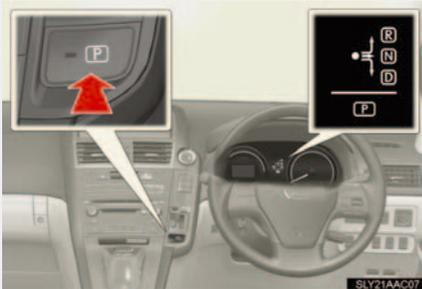
車を完全に停止させ、ブレーキペダルを踏みながら、P ポジションスイッチを押す
