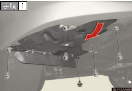
フォグライト下側のカバーの固定ボルト・クリップをはずし、カバーをめくる
