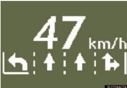
交差点にさしかかると交差点の手前（約300m以内）では、レーン表示（レーンと車速表示）に自動的に切りかわります。
