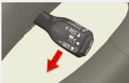
希望の速度まで加速 / 減速し、レバーを下げて速度を設定する
