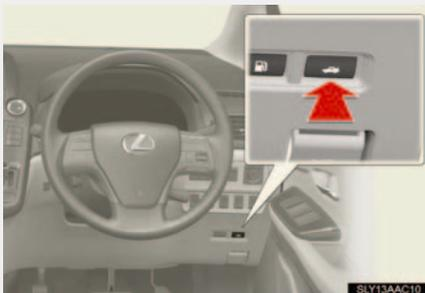
トランクオープナースイッチを押して、トランクのロックを解錠する
