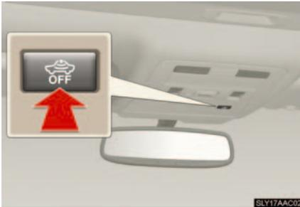
“パワー”スイッチをOFFにし、侵入センサーOFFスイッチを押したあと、オートアラームを設定してください。(→P. 98)
