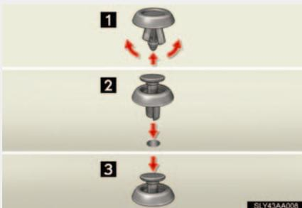
クリップの中央部分を押し上げ、挿し込みます。
