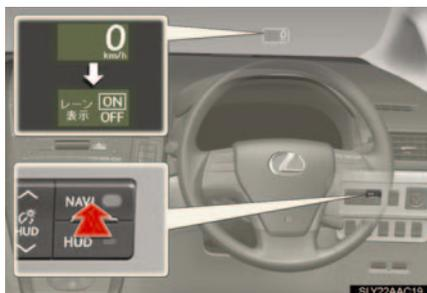
NAVI スイッチを2秒以上押すと、レーン表示のON/OFF切りかえ画面に移行します。NAVI スイッチを押すごとに ON/OFF は切りかわります。
