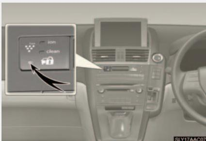
ドア・トランク・ボンネットを閉め、すべてのドアをスマートエントリー&スタートシステムまたはワイヤレスリモコンにて施錠します。30秒以上経過すると、自動的に設定されます。
