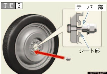
応急用タイヤを取り付け、タイヤががたつかない程度まで手でナットを仮締めする
