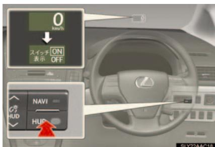
HUD (ヘッドアップディスプレイ) メインスイッチを2秒以上押すと、タッチトレーサディスプレイのON/OFF 切りかえ画面に移行します。HUD (ヘッドアップディスプレイ) メインスイッチを押すごとに ON/OFF は切りかわります。
