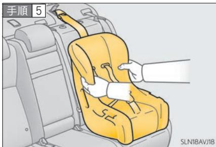
取り付けしたチャイルドシートを前後左右にゆすり、固定されていることを確認する
