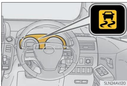
TRC・VSC・ABS が作動しているときは、スリップ表示灯が点滅します。
