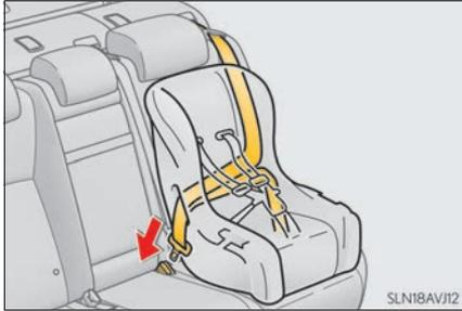
チャイルドシートにシートベルトを取り付け、プレートをバックルに“カチツ”と音がするまで挿し込む。ベルトがねじれていないようにする。
