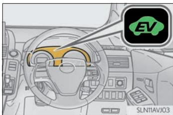
ガソリンエンジン停止中など、電気モーターのみで走行しているときに、EV 走行インジケータが点灯します。
