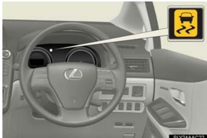
車両が横すべりしそうになったとき、タイヤが空転したときは、VSC・TRCの作動を表示するためにスリップ表示灯が点滅します。
