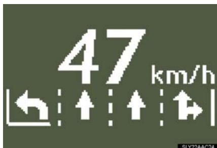
交差点にさしかかると交差点の手前（約300m以内）では、レーン表示（レーンと車速表示）に自動的に切りかわります。
