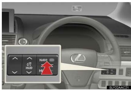
ヘッドアップディスプレイが ON のときは、簡易矢印ナビ（レーン表示も含む）の ON・OFF を切りかえる
