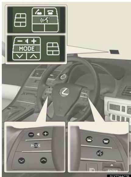
表示を切りかえるときは、ステアリングスイッチを操作します。
