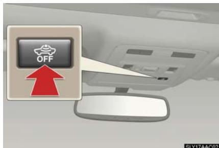
“パワー”スイッチを OFF にし、侵入センサー OFF スイッチを押したあと、オートアラームを設定してください。（→P. 100）
