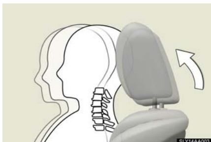
追突の衝撃によって、乗員の腰がシートバックを押すことでヘッドレストが少し斜め上方に動き乗員のむち打ち傷害軽減に貢献します。
