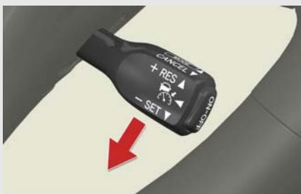
希望の速度まで加速 / 減速し、レバーを下げる速度を設定する
