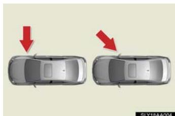
SRS サイドエアバッグと SRS カーテンシールドエアバッグは、前方や後方からの衝撃・横転・または低速での側面からの衝撃で作動するようには設計されていません。
