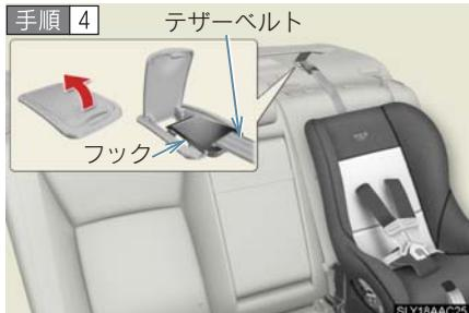
テザーベルトをピンと張り、フックがしっかりと固定されていることを確認します。
