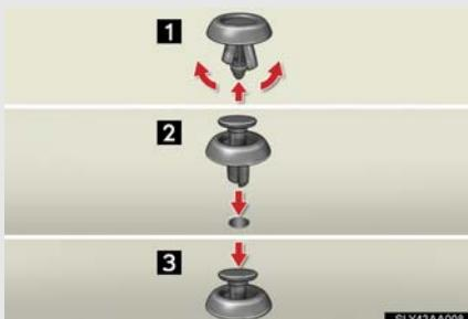
クリップの中央部分を押し上げ、挿し込みます。
