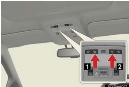
**1** ドアの開閉作動に連動してライトの点灯・消灯を切りかえる
