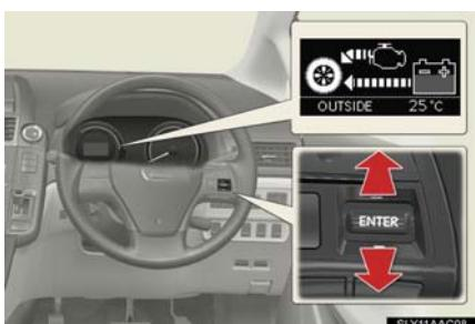
“ENTER”スイッチを上下に操作してエネルギーモニターを表示させる
