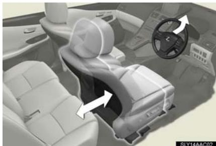
降車時：次のすべての操作を行つたとき、ハンドルが最上段・最前方に移動、運転席シートが後方に移動（オートアウェイ機能）
