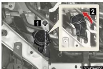
ウォツシャー液補給口の固定クリップをはずし、補給口の位置を移動させると、交換しやすくなります。
