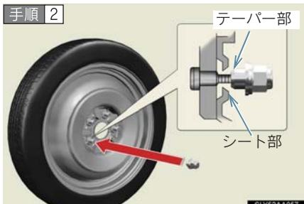
応急用タイヤを取り付け、タイヤががたつかない程度まで手でナットを仮締めする
