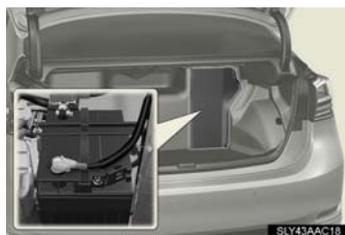
この車両の補機バッテリーは、ラゲージルーム（運転席側）のカバー内にあり、エンジンルームには搭載されていません。（補機バッテリーはバッテリー液の補充が必要ないタイプのため、バッテリー液量等の点検は不要です）
