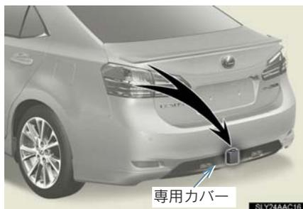
レーダーセンサーにより、後方から接近するものを検知し、その位置や速度、進路から追突する可能性を事前に判断します。
