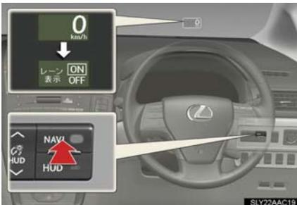
NAVI スイッチを2秒以上押すと、レーン表示のON/OFF切り換え画面に移行します。NAVI スイッチを押すごとに ON/OFF は切りかわります。
