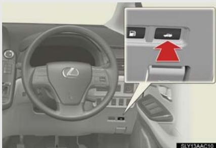
トランクオープナースイッチを押して、トランクのロックを解錠する
