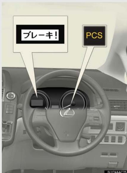
衝突の可能性があるとして検知したとき、「ピーピーピー」とブザー音が鳴り、PCS警告灯が点滅し、マルチインフォメーションディスプレイに衝突警告表示を出し、回避操作をうながします。
