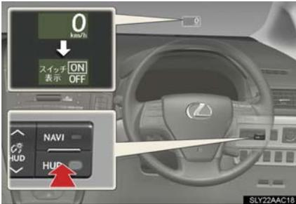
HUD (ヘッドアップディスプレイ) メインスイッチを2秒以上押すと、タッチトレーサディスプレイのON/OFF 切り換え画面に移行します。HUD (ヘッドアップディスプレイ) メインスイッチを押すごとに ON/OFF は切りかわります。
