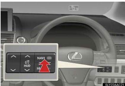
ヘッドアップディスプレイが ON のとき、簡易矢印ナビ (レーン表示も含む) の ON・OFF を切りかえる
