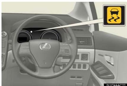
車両が横すべりしそうなとき、タイヤが空転したときは、VSC・TRCの作動を表示するためにスリップ表示灯が点滅します。
