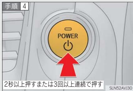
“パワー”スイッチを 2 秒以上押し続けるか、素早く 3 回以上連続で押してハイブリッドシステムを停止する。
