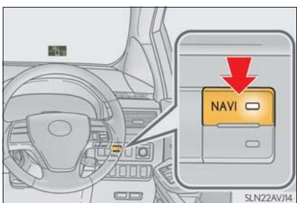
ヘッドアップディスプレイが ON のとき、簡易矢印ナビ（レーン表示も含む）の ON・OFF を切りかえる
