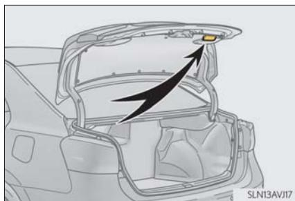
トランクグリップを持って、横方向に力をかけないようにトランクを引き下げ、外から押して閉めてください。
