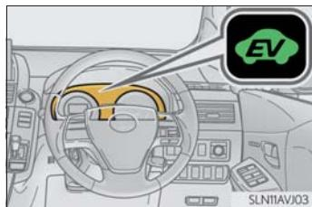
ガソリンエンジン停止中など、電気モーターのみで走行しているときに、EV 走行インジケーターが点灯します。
