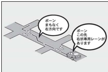
直進する交差点に右折（左折）専用レーンがある場合、その交差点に近づくと「この先 右折（左折）専用レーンがあります」と音声案内されます。目的地案内中で、右折（左折）する交差点では右折・左折専用レン案内はされません。この場合は「ボーン まもなく右方向（左方向）です」と音声案内されます。
