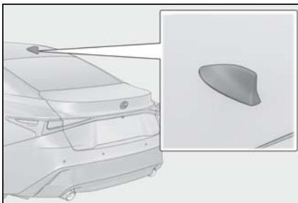
通信モジュール（DCM）は通信アンテナを使用します。
