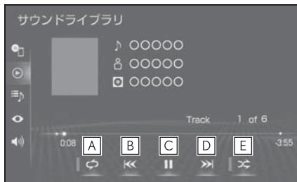
**A** 選択するたびに、再生中のトラックをリピート再生 → 再生中のアルバムをリピート再生 → リピート解除の順に切り替わります。
