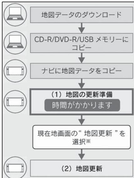
次回エンジンスイッチ<パワースイッチ>をアクセサリーモードまたはイグニッションONモード<ONモード>時に地図更新を行います。
