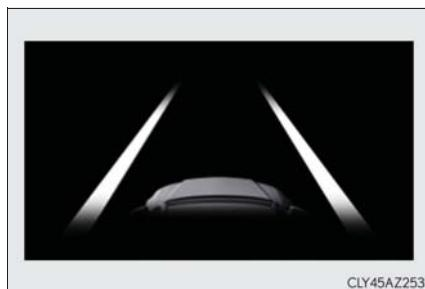
システムが白（黄）線を認識していることを示しています。車両が車線から逸脱した場合、逸脱している側の白線表示がオレンジで点滅します。
