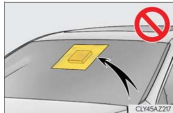
● カメラセンサー前部のフロントウインドウガラスが曇ったり、結露したり、凍結したりした場合は、フロントデフロスターで取り除く（→ P. 299）
