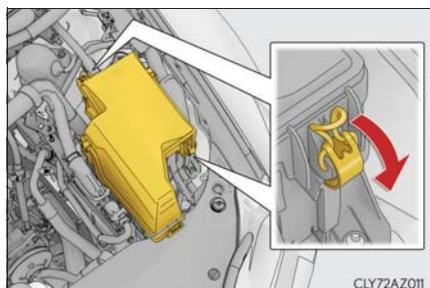
左右のツメを押してロックをはずし、手前のプレートを引きながらカバーを持ち上げる
