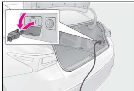
アース線のある電気製品を使用するときは、アース端子付きのコンセントを使用し、ラゲージルーム内コンセントを使用してアース線をアース端子に接続してください。
