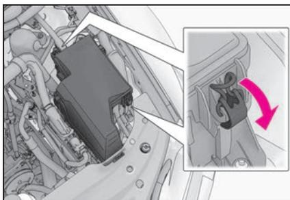
左右のツメを押してロックをはずし、手前のプレートを引きながらカバーを持ち上げる
