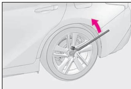
3 ジャッキの[A]部を手でまわして、ジャッキ溝をジャッキセット位置にしっかりかける
