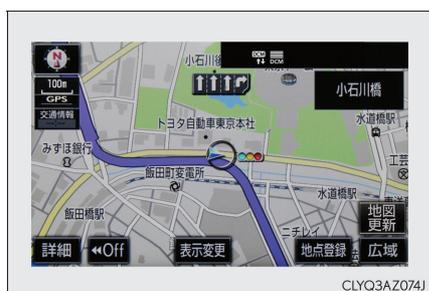
マップオンデマンド (地図更新サービス) は、通信またはパソコンを使って車載機の地図データを更新するサービスです。通信による自動更新では、アクセサリモードまたはイグニッション ON モード時ならびに目的地設定時にセンターへアクセスし、新しい地図データがあれば自動的にダウンロードします。
