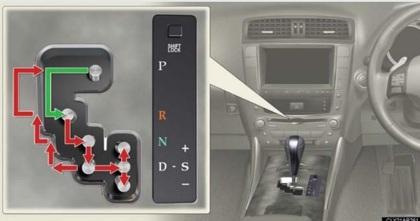
← “エンジンスタートストップ” スイッチがイグニッション ON モードの状態、ブレーキペダルを踏んだまま操作します。
