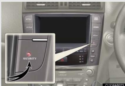
ドア・トランク・ボンネットを閉め、すべてのドアを施錠します。30 秒以上経過すると、自動的に設定されます。
