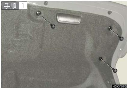
トランクを開け、トランクパネルカバーのクリップを取りはずす。
