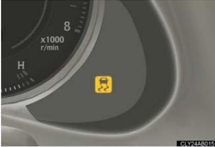
車両が横すべりしそうになったとき、後輪（FR車）または前後輪（AWD車）が空転したとき、坂道発進をしたときは、VSC、TRC、ヒルスタートアシストコントロールの作動を表示するためにスリップ表示灯が点滅します。
