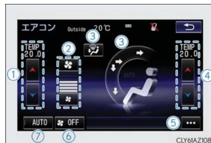
リモートタッチノブを操作して画面上のスイッチを選択し、リモートタッチノブを押して決定します。
