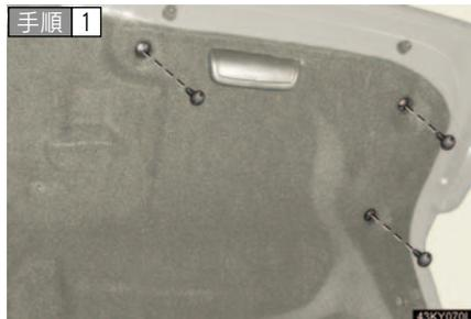
トランクを開け、トランクパネルカバーのクリップを取りはずす。
