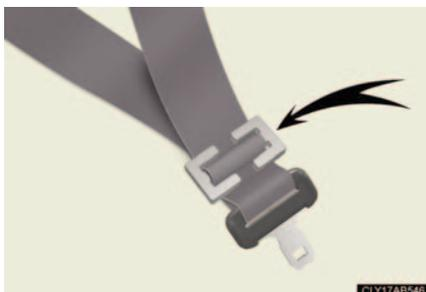
チャイルドシートにシートベルトのロック機構が備わっていない場合は、ロッキングクリップ（別売）を使用して固定する。
