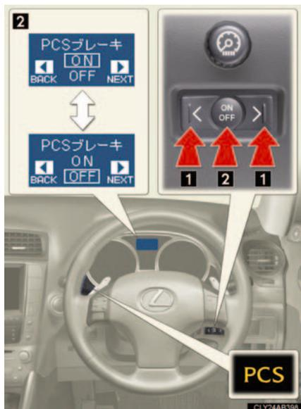
サテライトスイッチの **◀** 側または **▶** 側を押して、PCS ブレーキの設定モードにする。**(1)** サテライトスイッチの中央のON/OFF ボタンを押して、ON または OFF に設定する。**(2)**
