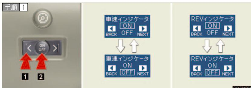
サテライトスイッチの「**<**」側または「**>**」側を押し、車速インジケータ・REV インジケータの設定項目表示にする。(1) ON/OFF ボタンで OFF にしてから ON に設定する。(2)
