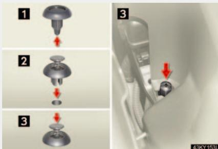
**1** 机のような固い面にクリップの先端を押しあて、クリップの中央部分を押しあげます
