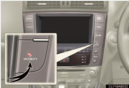
ドア・トランク・ボンネットを閉め、すべてのドアを施錠します。30 秒以上経過すると、自動的に設定されます。
