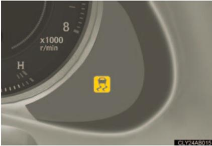
車両が横すべりしそうになったとき、後輪（FR車）または前後輪（AWD車）が空転したとき、坂道発進をしたときは、VSC、TRC、ヒルスタートアシストコントロールの作動を表示するためにスリップ表示灯が点滅します。
