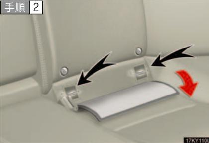
カバーをめくり、ISOFIX 対応チャイルドシート固定専用バーの位置を確認する。
