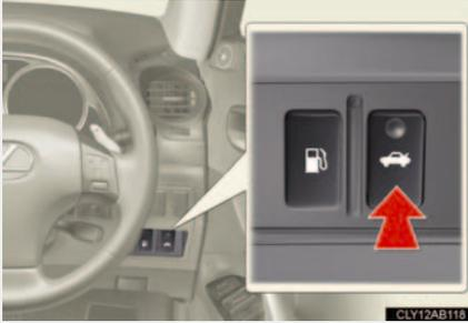
トランクオープナースイッチを押して、トランクのロックを解除する
