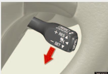
希望の速度まで加速 / 減速し、レバーを下げて速度を設定する
