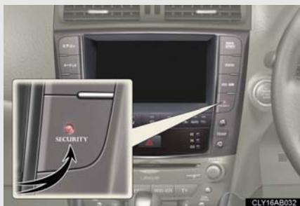
ドア・トランク・ボンネットを開め、スマートエントリー＆スタートシステム、ワイヤレスリモコンを使って施錠します。30秒以上経過すると、自動的に設定されます。
