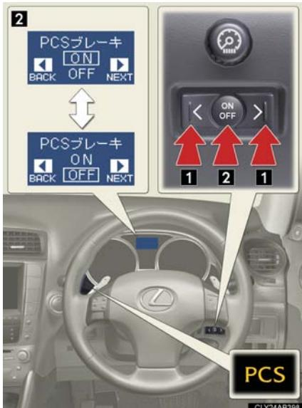
サテライトスイッチの  $\blacktriangleleft$  側または  $\triangleright$  側を押して、PCS ブレーキの設定モードにする。(1) サテライトスイッチの中央のON/OFFボタンを押して、ON または OFF に設定する。(2)
