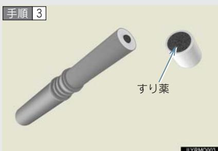
先端のふたをとり、すり薬で発炎筒の先端をこすり、着火させる。
