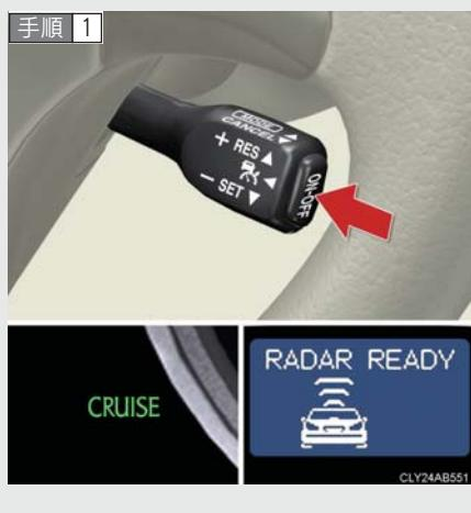
ON-OFF スイッチを押してシステムを ON にする
