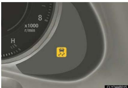
VSC、TRC、ヒルスタートアシストコントロールが作動しているときは、スリップ表示灯が点滅します。
