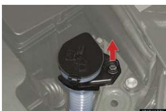
ウォツシャー液補給口の固定ボルトをはずし、補給口の位置を移動させると、交換しやすくなります。
