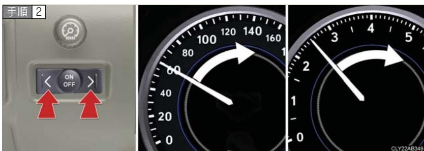
6 秒以内にサテライトスイッチの【<（側または）>】側を希望の速度・エンジン回転数になるまで押し、ON/OFF ボタンを押して、設定を ON にする。
