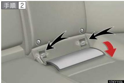
カバーをめくり、ISOFIX 対応チャイルドシート固定専用バーの位置を確認する。
