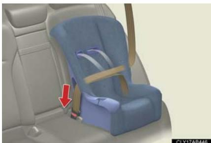
チャイルドシートにシートベルトを取り付け、プレートをバックルに“力チツ”と音がするまで差し込む。ベルトがねじれていないようにする。
