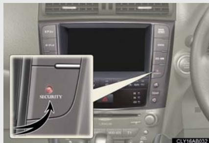
ドア・トランク・ボンネットを開め、スマートエントリー＆スタートシステム、ワイヤレスリモコンを使って施錠します。30秒以上経過すると、自動的に設定されます。
