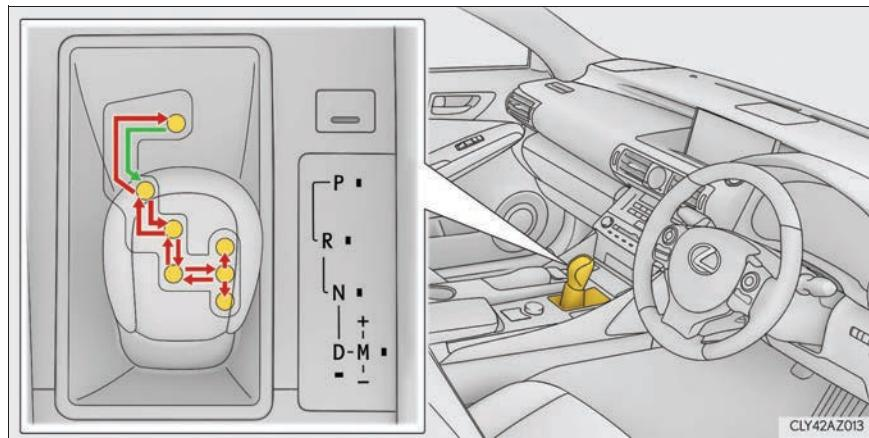
エンジンスイッチがイグニッショナONモードの状態で、ブレーキペダルを踏んだまま操作します。
