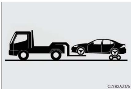
台車を使用して後輪を持ち上げる
