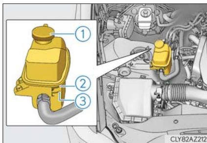
**5** 冷却水が不足している場合は、冷却水を補給する
