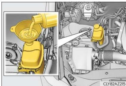
冷却水がない場合は、応急措置として水を補給してください。
