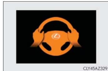
さらに操作しない状態が続くとブザーが鳴り、マルチインフォメーションディスプレイにメッセージと図に示すシンボルが表示され注意喚起が行われ、機能が一時的に解除されます。運転者のハンドル操作が小さい状態が続いたときも同様に注意喚起が行われます。システムを使用する際は注意喚起にかかわらず、常にハンドルをしっかりと握ってください。
