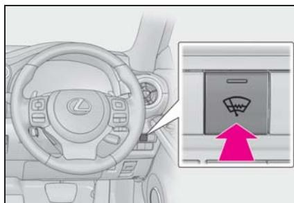
ウインドシールドデアイサーが ON のとき、スイッチの作動表示灯が点灯します。ウインドシールドデアイサーは、しばらくすると自動的に OFF になります。
