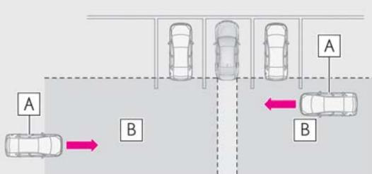
**A 接近車両****B 接近車両を検知できる範囲****■ RCTA アイコンの表示**
