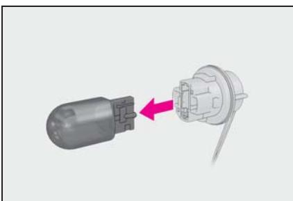
**8 新しい電球を取り付け、ソケットをランプ本体に挿し込み右にまわして取り付ける**
