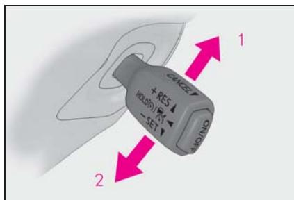
**1 速度を上げる（車間制御モードの制御停車中は除く）**
