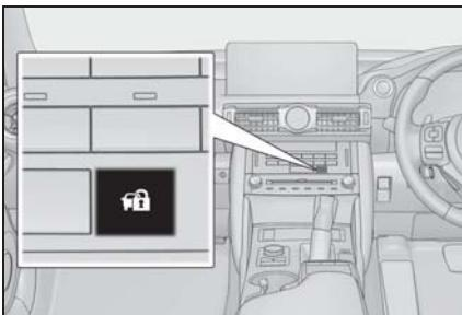
エンジンスイッチを OFF になると、システムの作動を知らせるためにインジケーターが点滅します。
