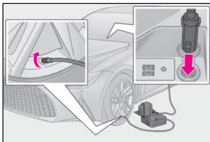
**21**コンプレッサーのスイッチを約5秒間ONにし、OFFにしてから空気圧を確認する
