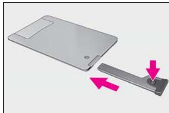
●電池カバーがはずれたときやぬれたときに電池をはずした場合は、電池の+極をレクサスエンブレム面側にして取り付けてください。
