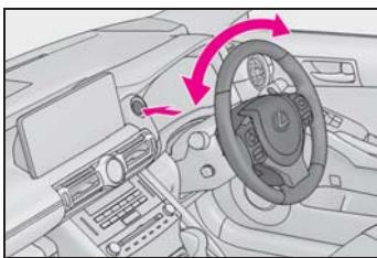
● 短時間にエンジンの始動・停止をくり返すと、モーターのオーバーヒート防止のために作動制限することがあります。その場合は操作を控えてください。10秒程度でもとの状態にもどります。
