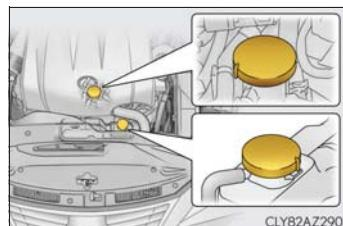
● IS300：エンジンおよびラジエーターが熱い場合は冷却水リザーバータンクのキャップや注水キャップまたは、インタークーラーリザーバータンクのキャップを開けないでください。
