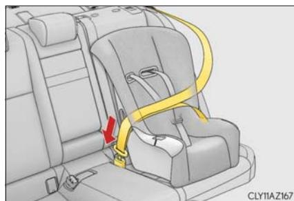
**4** チャイルドシートにシートベルトを取り付け、プレートをバツクリに“カチッ”と音がするまで挿し込む。ベルトがねじれていないようにする
