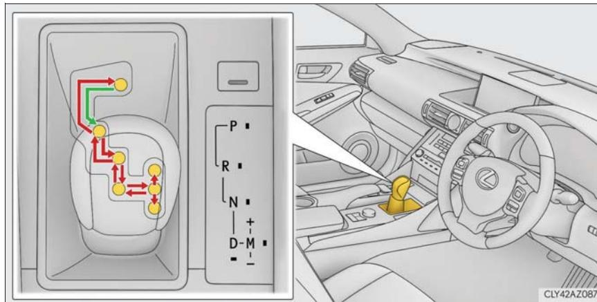
← エンジンスイッチがイグニッショ n ON モードの状態で、ブレーキペダルを踏んだまま操作します。
