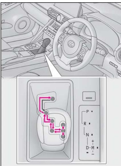
エンジンスイッチがイグニッションONモードの状態で、ブレーキペダルを踏んだまま操作します。PとDのあいだの操作は、ブレーキペダルを踏み、車を完全に止めてから行ってください。
