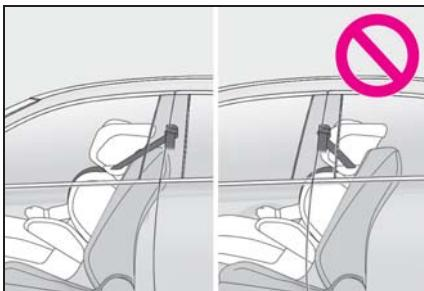
最も快適な位置に調整します。また、シートベルトのショルダーアンカーがチャイルドシートベルトガイドより前にある場合は、シートを前方に移動します。
