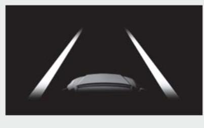
システムが白（黄）線または走路※を認識していることを示しています。車両が車線から逸脱した場合、逸脱している側の白線表示がオレンジで点滅します。
