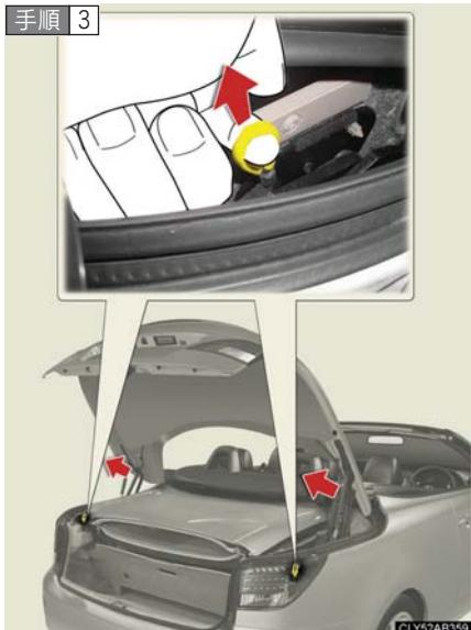
トランクの両側についている黄色い輪を引きながら、トランクリッドの前側を持ち上げる
