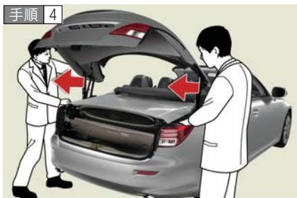
イラストと同じ部分を持ち、トランクリッドを車両後方へ持ち上げ、止まる位置まで動かす
