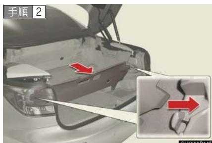
ラッゲージカバーを引き出し、ボード部の上部を左右のホルダーに差し込みます。
