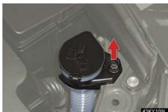
ウォツシャー液補給口の固定ボルトをはずし、
