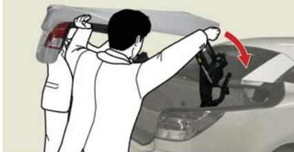
イラストと同じ部分を持ち、トランクリッドを車両の前方に押し下げロックする
