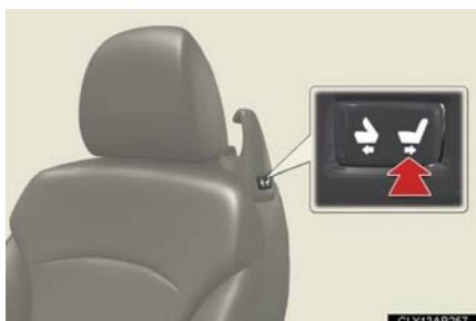
スイッチの後方側をブザーが鳴るまで押すと、フロント席が後ろへ移動します。
