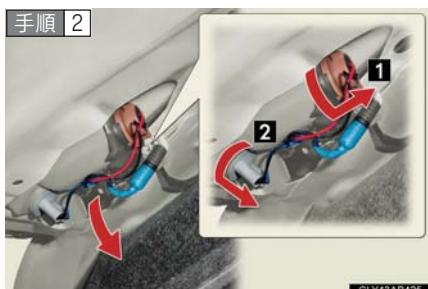
トランクパネルカバーの一部をはずし、ソケットを取りはずす。
