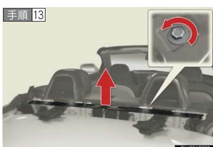
前側のプレートの固定ボルトを 4 本はずして、前側のプレートをはずす
