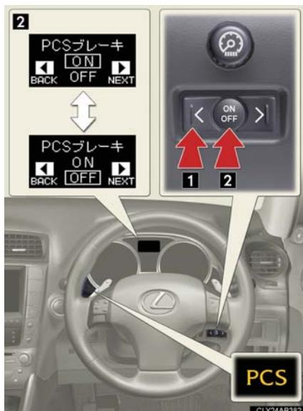
サテライトスイッチの  $\blacktriangleleft$  または  $\triangleright$  を押して、PCS ブレーキの設定モードにする。(1) サテライトスイッチの中央のON/OFFボタンを押して、ON または OFF に設定する。(2)
