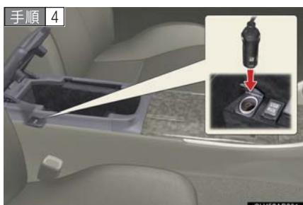
キットの電源プラグをアクセサリーソケットに差し込む。 (→P. 195)
