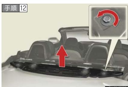
後ろ側のプレートの固定ボルトを 6 本はずして、後ろ側のプレートをはずす
