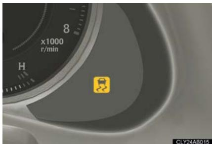
車両が横すべりしそうになったとき、後輪が空転したとき、坂道発進をしたときは、VSC、TRC の作動を表示するためにスリップ表示灯が点滅します。
