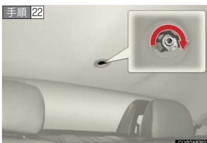
六角レンチを差しこみ、時計回りに、止まるまでまわして、リヤウインドウパネルとルーフパネルをロックする
