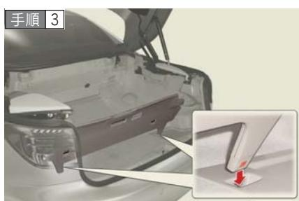
ボード部の下部を、フロアにある左右のホルダーに差し込みます。
