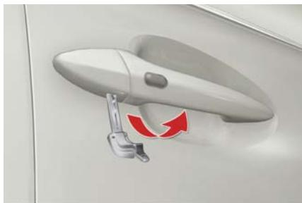
メカニカルキー（→P. 21）を使って、運転席側のカバーを取りはずした後操作します。
