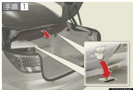
ラッゲージカバーのボード部を手前に引き倒し、フックから外します。
