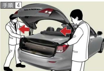
イラストと同じ部分を持ち、トランクリッドを車両後方へ持ち上げ、止まる位置まで動かす
