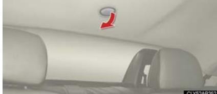
六角レンチを差しこみ、時計回りに、止まるまでまわして、リヤウインドウパネルとルーフパネルをロックする
