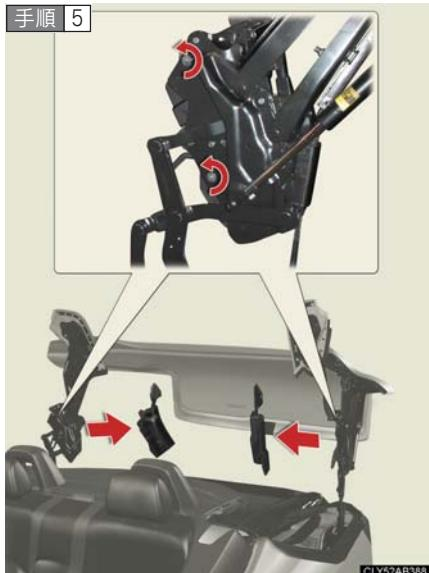
トランクリッドヒンジの両側にあるスクリューをそれぞれ2本はずして、カバーをはずす
