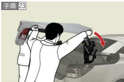
イラストと同じ部分を持ち、トランクリッドを車両の前方に押し下げロックする
