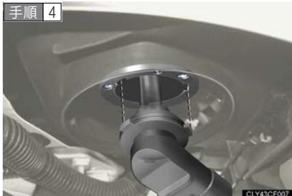
電球を交換し、ソケットを取り付ける
