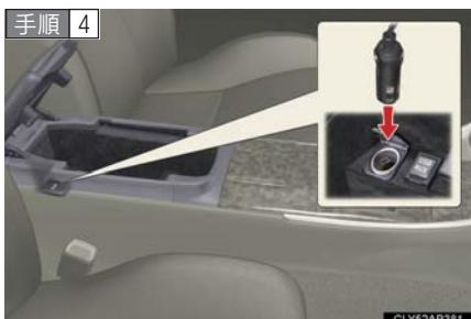
キットの電源プラグをアクセサリーソケットに差し込む。(→P. 216)
