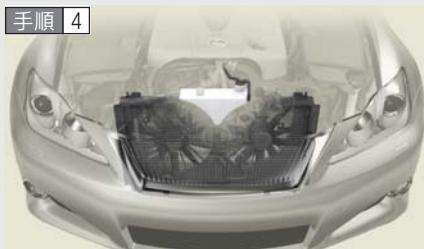
エンジンが十分に冷えてから、冷却水の量やラジエーターコア部(放熱部)の冷却水漏れを点検する。
