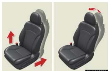
やむを得ず助手席に子供専用シートを取り付ける場合には、助手席シートを以下のように調整し、子供専用シートを前向きに取り付けてください。
