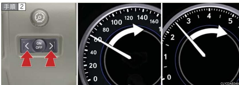
6 秒以内にサテライトスイッチの [< (または) >] を希望の速度・エンジン回転数になるまで押し、ON/OFF ボタンを押して、設定を ON にする。
