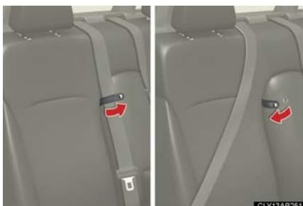
リヤシートベルトを使用しないときはホルダーで固定し、使用するときは必ずホルダーからベルトをはずしてください。
