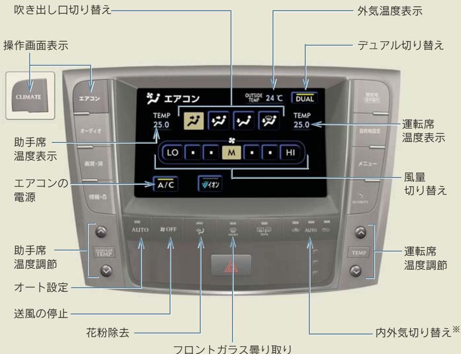
※ イラストは排ガス検知式内外気自動切り替えシステム装着車
