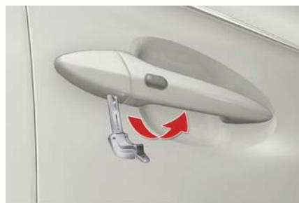
メカニカルキーを使って、運転席側のカバーを取りはずした後操作します。
