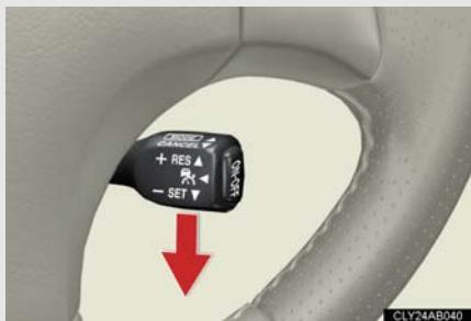
希望の速度まで加速 / 減速し、レバーを下げるで速度を設定する
