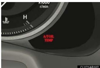
走行中にオートマチックトランスミッション油温警告灯が点灯したときは、D ポジションの通常走行に切り替えたうえでアクセルをゆるめ、車速を落としてください。
