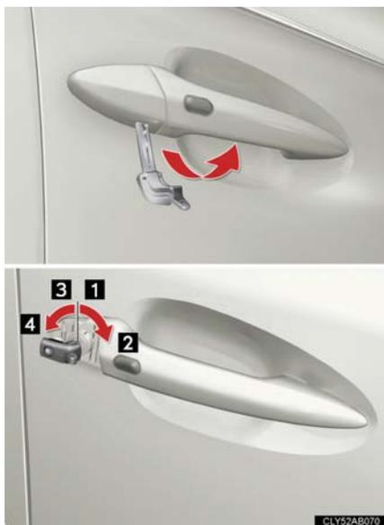
メカニカルキーを使って、運転席側のカバーを取りはずした後操作します。
