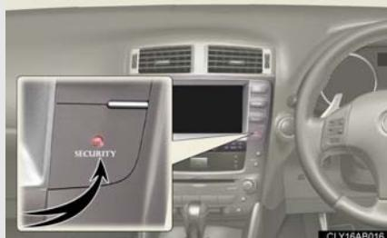
ドア・トランク・ボンネットを閉め、すべてのドアを施錠します。30 秒経過すると、自動的に設定されます。
