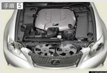
エンジンが十分に冷えてから、冷却水の量やラジエーターコア部(放熱部)の冷却水漏れを点検する。
