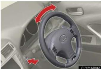
マルチディスプレイにメッセージが表示され、“エンジンスタートストップ” スwitch上のインジケーターが緑色に点滅します。ハンドルを左右にまわしながら再操作してください。
