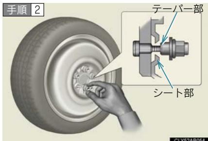
スペアタイヤを取り付け、タイヤががたつかない程度まで手でナットを仮締めする。
