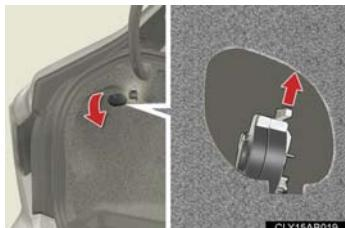
バッテリーがあがつたりその他の原因で給油口が開けられないときは、トランク内のレバーを引きます。
