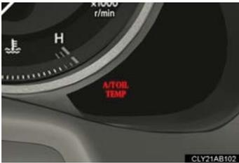
走行中にオートマチックトランスミッション油温警告灯が点灯したときは、D ポジションの通常走行に切り替えたうえでアクセルをゆるめ、車速を落としてください。安全な場所に車両を停止させ、シフトレバーを P ポジションにシフトして、警告灯が消灯するまでアイドリング状態にしてください。消灯後、再び走行することができます。しばらくしても消灯しないときは、レクサス販売店で点検を受けてください。
