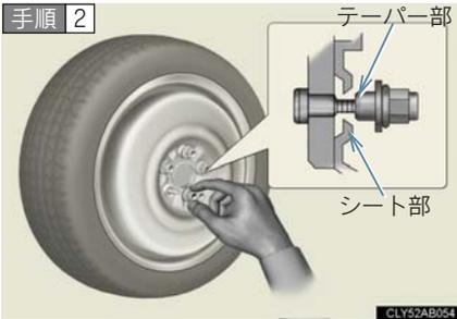
スペアタイヤを取り付け、タイヤががたつかない程度まで手でナットを仮締めする。
