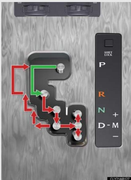
← “エンジンスタートストップ”スイッチがイグニッションONモードの状態、ブレーキペダルを踏んだまま操作します。
