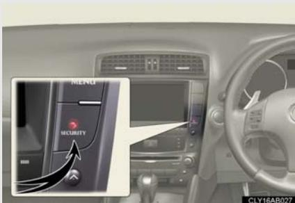
ドア・トランク・ボンネットを閉め、すべてのドアを施錠します。30秒経過すると、自動的に設定されます。
