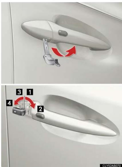
メカニカルキー (→P. 21) を使って、運転席側のカバーを取りはずした後操作します。
