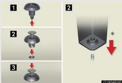
1 机のような固い面にクリップの先端を押しあて、クリップの中央部分を押し上げる
