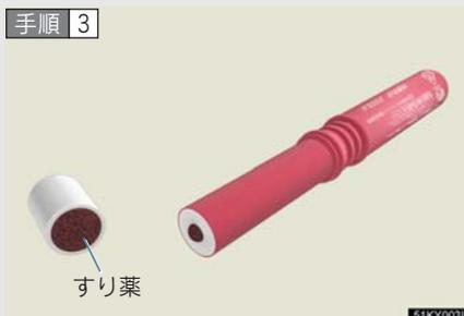
先端のふたをとり、すり薬と発炎筒の先端をこすり、着火させる。
