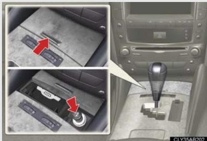
灰皿のふたを開けて、シガレットライターを押し込む
