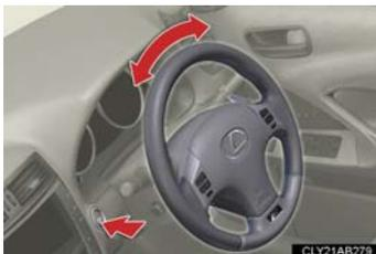
マルチディスプレイにメッセージが表示され、“エンジンスタートストップ” スイッチ上のインジケーターが緑色に点滅します。ハンドルを左右にまわしながら再操作してください。
