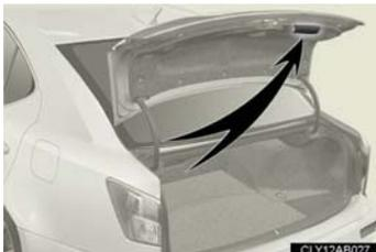
トランクを引き下げるときにお使いください。引き下げるときは、トランクグリップを持って、横方向に力をかけないように引き下げます。
