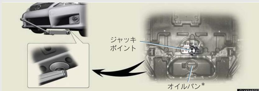
\* :エンジンのオイルパンが、ジャッキポイントと間違えやすい形状をしているため、ガレージジャッキ取り付け時は注意してください。
