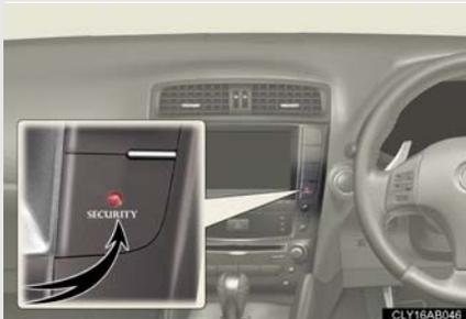
“エンジンスタートストップ”スイッチを OFF にすると、システムの作動を知らせるためにインジケータが点滅します。
