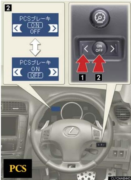
サテライトスイッチの“<”または“>”を押して、PCS ブレーキの設定モードにする。(1) サテライトスイッチの ON/OFF ボタンを押して、ON または OFF に設定する。(2)
