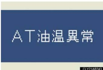
走行中にオートマチックトランスミッション油温の警告メッセージが表示されたときは、Dポジションの通常走行に切り替えただうえてアクセルをゆるめ、車速を落としてください。安全な場所に車両を停止させ、シフトレバーをPポジションにシフトして、警告メッセージが消灯するまでアイドリング状態にしてください。
