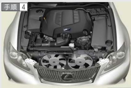
エンジンが十分に冷えてから、冷却水の量やラジエーターコア部（放熱部）の冷却水漏れを点検する。
