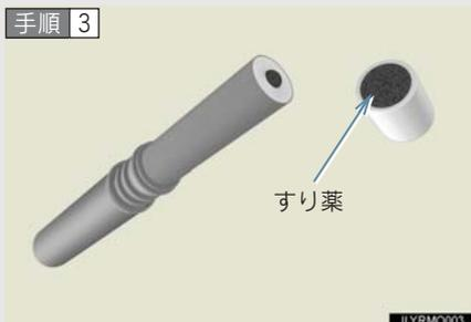
先端のふたととり、すり薬で発炎筒の先端をこすり、着火させる。
