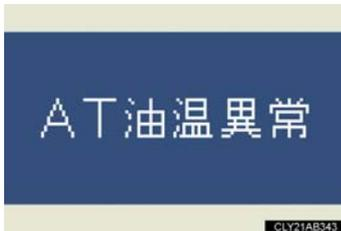
走行中にオートマチックトランスミッション油温の警告メッセージが表示されたときは、Dポジションの通常走行に切り替えただけでアクセルをゆるめ、車速を落としてください。安全な場所に車両を停止させ、シフトレバーをPポジションにシフトして、警告メッセージが消灯するまでアイドリング状態にしてください。
