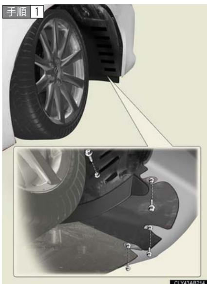
交換するライトの反対側へハンドルをまわし、タイヤの向きをかえる。フェンダーライナー固定ボルトをはずす。
