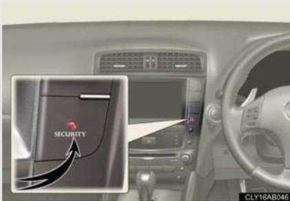
“エンジンスタートストップ”スイッチを OFF にすると、システムの作動を知らせるためにインジケータが点滅します。
