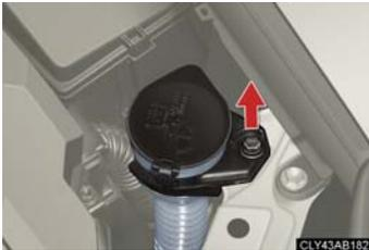
ウォッシャー液補給口の固定ボルトをはずし、補給口の位置を移動させると、交換しやすくなります。
