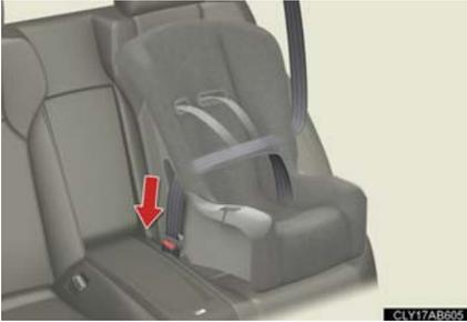
チャイルドシートにシートベルトを取り付け、プレートをバックルに“カチツ”と音がするまで差し込む。ベルトがねじれていないようにする。
