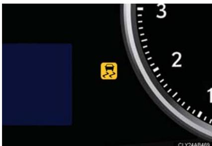
VSC、TRC、ヒルスタートアシストコントロールが作動しているときはスリップ表示灯が点滅します。
