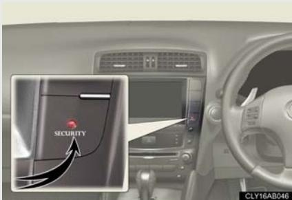
ドア・トランク・ボンネットを開め、すべてのドアを施錠します。30 秒経過すると、自動的に設定されます。
