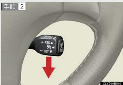
希望の速度まで加速 / 減速し、レバーを下げるで速度を設定する
