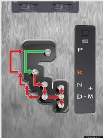
“エンジンスタートストップ”スイッチがイグニッションONモードの状態で、ブレーキペダルを踏んだまま操作します。
