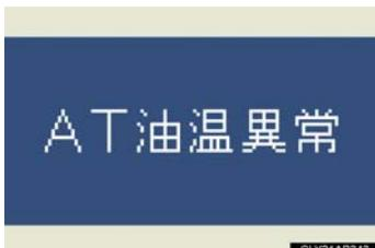
走行中にオートマチックトランスミッション油温の警告メッセージが表示されたときは、D ポジションの通常走行に切り替えたうえでアクセルをゆるめ、車速を落としてください。安全な場所に車両を停止させ、シフトレバーを P ポジションにシフトして、警告メッセージが消灯するまでアイドリング状態にしてください。
