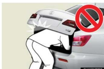
● 半開状態で使用すると、トランクリッドが突然閉じて重大な傷害を受けるおそれがあります。とくに傾斜地では、平坦な場所よりもトランクの開閉がしにくく、急にトランクが開いたり閉じたりするおそれがあります。必ずトランクが全開で静止していることを確認して使用してください。
