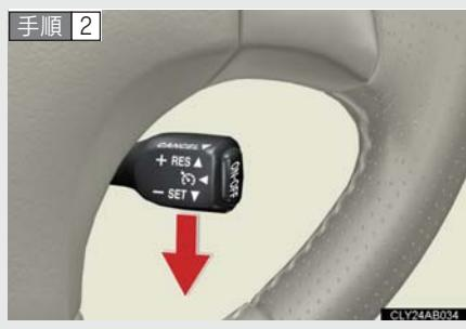
希望の速度まで加速／減速し、レバーを下げる速度を設定する
