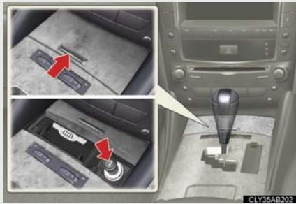
灰皿のふたを開けて、シガレットライターを押し込む
