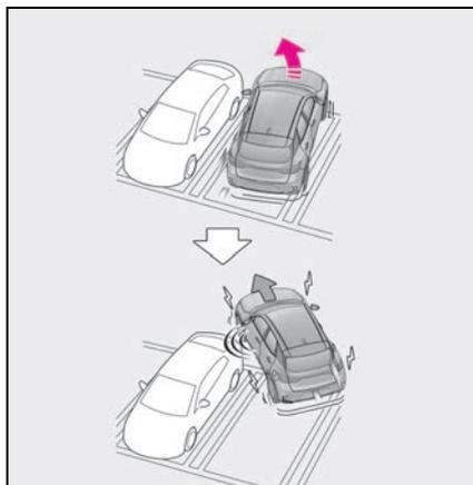
■ 後退中に外輪差で巻き込みによる衝突
