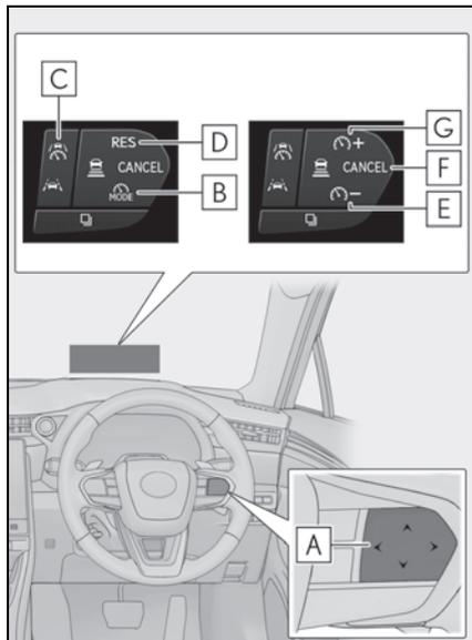
**A** 状況や設定によって、スイッチの機能がかわります。スイッチに触れると、各スイッチの機能がヘッドアップディスプレイに表示されます。ヘッドアップディスプレイがOFFのときはマルチインフォメーションディスプレイに表示されます
