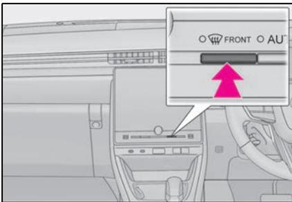
除湿機能が作動し、風量が増えます。内気循環にしている場合は、外気導入にしてください。(自動的に外気導入に切りかわることがあります)
