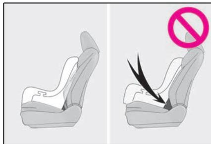
※3ヘッドレストとチャイルドシートが干渉してチャイルドシートが正しく取り付けられない場合、ヘッドレストの取りはずしが可能なときは、ヘッドレストを取りはずしてください。取りはずしができない場合は、ヘッドレストをいちばん上まで上げてください。
