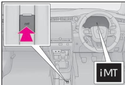
iMT 表示灯が点灯します。解除するには再度 iMT スイッチを押します。
