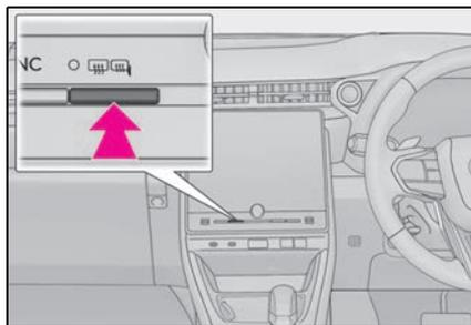
リヤウインドウデフォグガーを作動させると、ミラーヒーターが同時に作動し、曇りを取ることができます。
