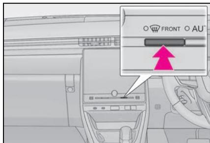
除湿機能が作動し、風量が増えます。内気循環にしている場合は、外気導入にしてください。(自動的に外気導入に切りかわることがあります)
