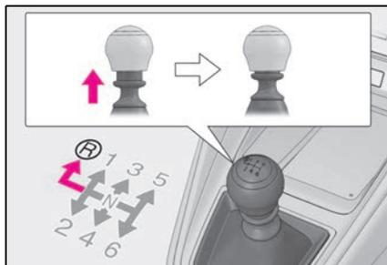
シフトレバーが R に入りにくいときは、シフトレバーを N に入れ、クラッチペダルを踏み直してから、再度シフト操作してください。
