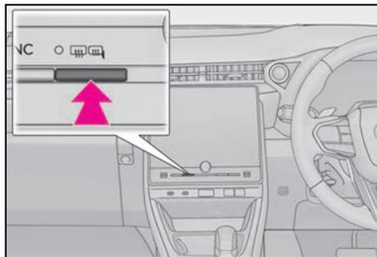
リヤウインドウデフォグガーを作動させると、ミラーヒーターが同時に作動し、曇りを取ることができます。
