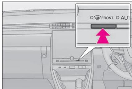
除湿機能が作動し、風量が増えます。内気循環している場合は、外気導入にしてください。(自動的に外気導入に切りかわることがあります)
