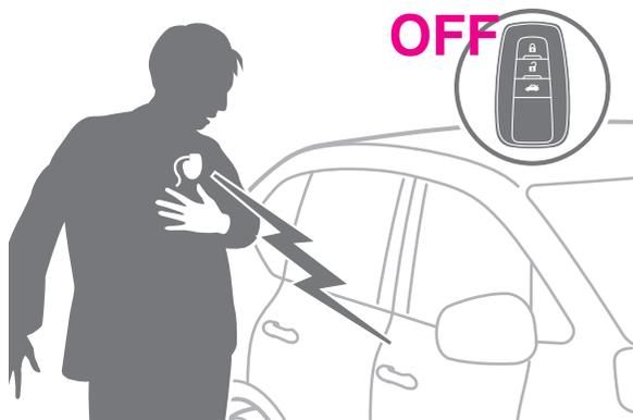
スマートエントリー&スタートシステムは、電子キーと車のアンテナとの間で微弱な電波の送受信を行っています。
