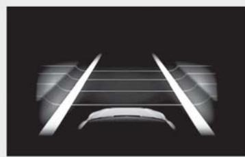
システムが白（黄）線を認識していることを示しています。車両が車線から逸脱した場合、逸脱している側の白線表示が橙色で点滅します。
