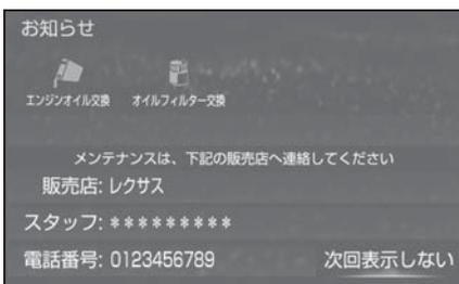
オイルなどの消耗部品の交換時期・各種点検時期・免許証の更新などのイベント時期の案内を行う機能です。各メンテナンス項目について、あらかじめ設定した日付や走行距離に達すると、システム起動時に案内が表示されます。
