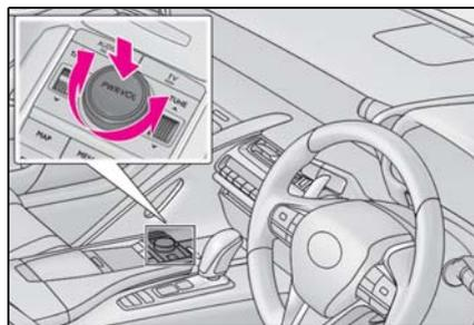
“PWR・VOL” ノブ：押すごとに電源の ON と OFF が切り替わります。回すと音量が切り替わります。
