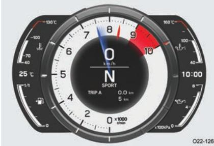
6000 r/min 以上の回転域でエンジン回転数の最高値にタコメーター指針の残像を約 0.5 秒間表示します。
