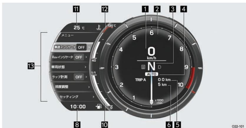
**1** スピードメーター**2** タコメーター**3** ギヤ段表示 (→P. 86)**4** 走行モード表示 (→P. 86)**5** ドライブモニター表示
