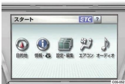
ETC カードを挿入すると、スタート画面に ETC マークが表示されます。
