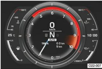
エンジン保護のため、エンジン冷却水温の上昇にあわせて、タコメーターのレッドゾーン範囲が4400 r/minから9000 r/minまで可変します。
