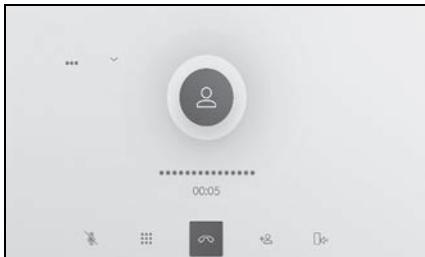
[]：通話相手に発話した声が聞こえないように、送話音をミュート（消音）します。ミュート（消音）中はボタンが青くなります。解除するときは、再度ボタンにタッチします。
