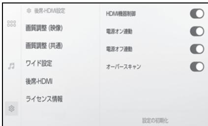
[HDMI 機器制御]※<sup>1</sup> : リヤシートエンターテインメントシステムによる HDMI 機器の操作の ON/OFF を切りかえることができます。ON にすると、HDMI 機器をリヤシートエンターテインメントシステム側で操作できるようになります。
