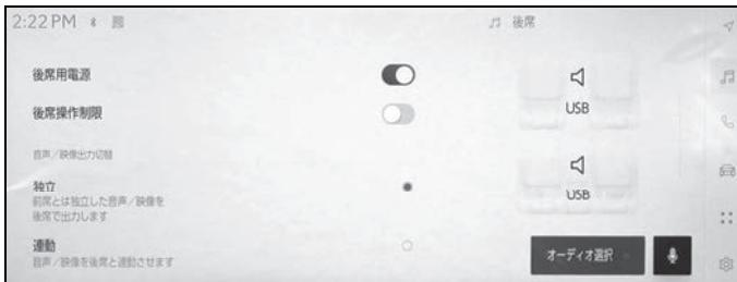
[後席用電源]：リヤシートエンターテインメントシステムの電源をON/OFFします。
