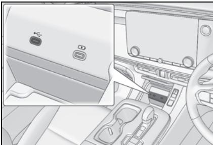
USB メモリーを接続するときは USB Type-C 端子に直接接続してください。
