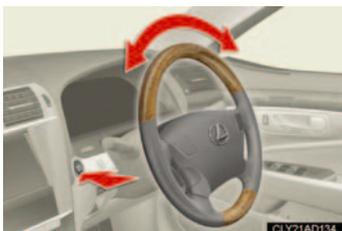
マルチインフォメーションディスプレイにメッセージが表示され、“エンジンスタートストップ”スイッチ上のインジケーターが緑色に点滅します。ハンドルを左右にまわしながら再操作してください。
