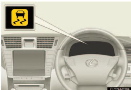
車が横すべりしそうになったとき、タイヤが空転したとき、坂道発進をしたときは、VSC、TRC、ヒルスタートアシストコントロールの作動を表示するためにスリップ表示灯が点滅します。
