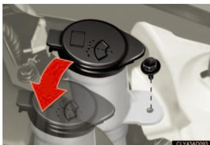
ウォッシャー液補給口の固定ボルトをはずし、補給口の位置を移動する。
