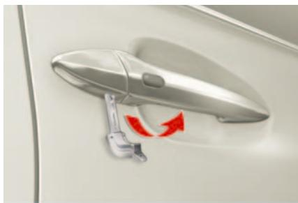
メカニカルキー（→P. 31）を使って、運転席側のカバーを取りはずしたあと操作します。
