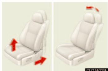
やむを得ず助手席に子供専用シートを取り付ける場合には、助手席シートを以下のように調整し、子供専用シートを前向きに取り付けてください。
