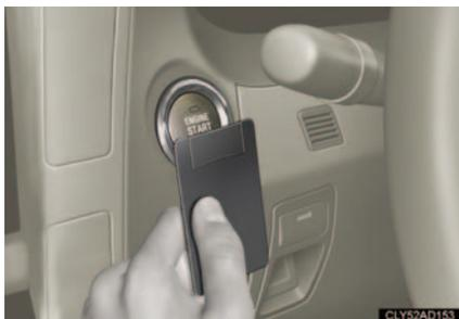
**手順 3** モードの切り替え：ブザーが鳴ってから 10 秒以内に、ブレーキペダルから足をはなして“エンジンスタートストップ”スイッチを押します。“エンジンスタートストップ”スイッチを押すごとにモードが切り替わります。(→ P. 145)
