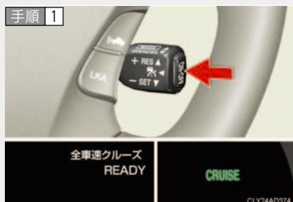
ON-OFF スイッチでシステムをONにする
