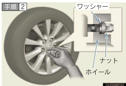
タイヤを取り付け、タイヤがたつかない程度まで手でナットを仮締めする。
