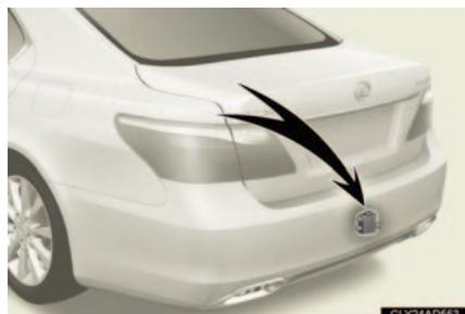
レーダーセンサーにより、後方から接近するものを検知し、その位置や速度、進路から追突する可能性を事前に判断します。
