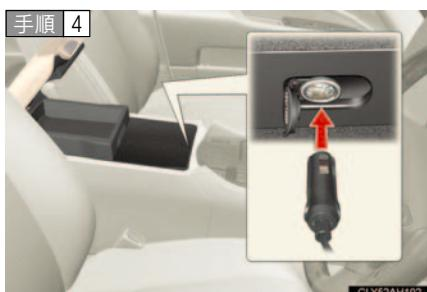
キットの電源プラグをアクセサリーソケットに差し込む。(→P. 280)
