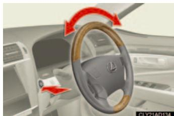
マルチインフォメーションディスプレイにメッセージが表示され、“エンジンスタートトップ”スイッチ上のインジケーターが緑色に点滅します。ハンドルを左右にまわしながら再操作してください。
