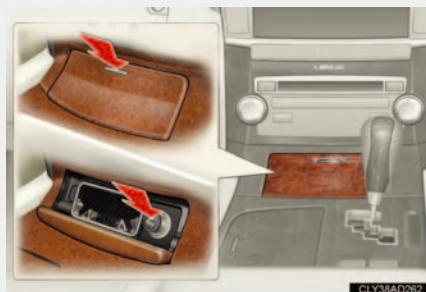
灰皿のふたを開けて、シガレットライターを押し込みます。
