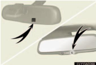
センサーの誤作動を防ぐため、センサーに触れたりセンサーを覆ったりしないでください。
