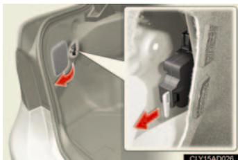
車内のスイッチを押しても給油口が開かないときは、トランク内のレバーを引きます。
