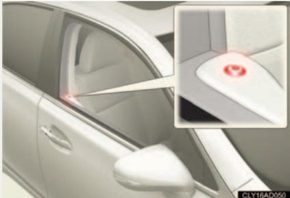
“エンジンスタートストップ”スイッチを OFF にすると、システムの作動を知らせるためにインジケーターが点滅します。
