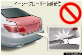
トランクが半ドア状態になったとき、イージークローザーが働き自動で完全に閉まります。また、作動し始めるまでに数秒かかります。指などをトランクの間に挟まないように注意してください。骨折など重大な傷害を受けるおそれがあり危険です。
