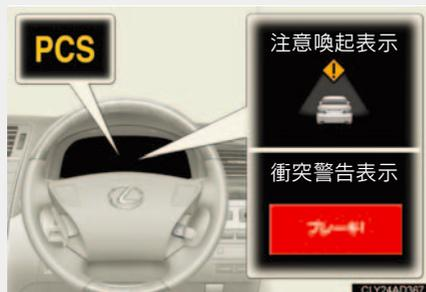
衝突の可能性があると検知したとき、注意喚起表示が出ます。さらに衝突の可能性が高い場合には、衝突警告表示を出し、回避操作を促します。
