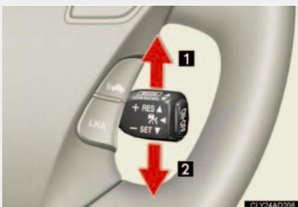
希望の速度（約 50 km/h ~ 100 km/h）まで加速 / 減速し、レバーを下げて速度を設定する
