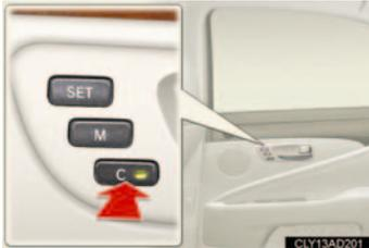
C ボタンを押すと、ポジションの呼び出し作動やドア連動シートリターン機能がキャンセルされます。
