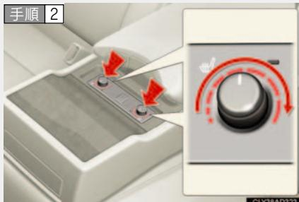
ツマミを押して ON にします。左右にまわして温度を設定します。
