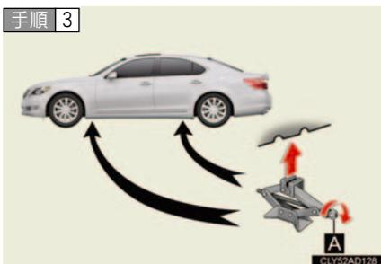
ジャッキの A 部を手でまわして、ジャッキ溝をジャッキセット位置にしっかりかける。
