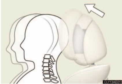
追突の衝撃を車両が感知することで、ヘッドレスト前面が斜め上方に動き、乗員のむち打ち傷害軽減に貢献します。
