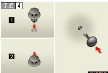
固定ボルトとクリップを取り付ける。
