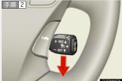
希望の速度まで加速 / 減速し、レバーを下げる速度を設定する
