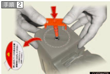
キット底面を上に向けてシールをはがし、差し込みパーツを押し込む。
