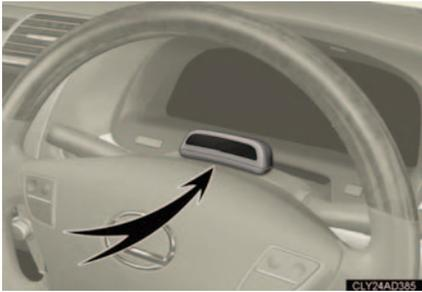
運転者の顔をモニターし、正面を向いていない状態・目を閉じている状態をシステムが判断します。
