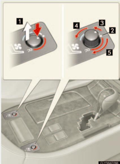
**1** ツマミを押し出します。左右にまわして温度を設定します。
