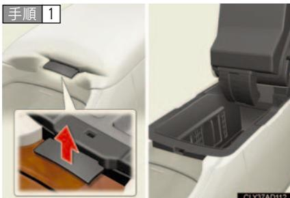
レバーを引き上げてロックを解除し、アームレストを持ち上げる。
