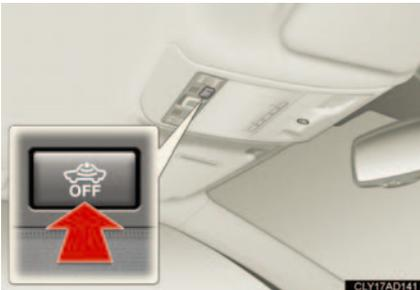
“エンジンスタートストップ”スイッチを OFF にし、侵入センサー OFF スイッチを押す
