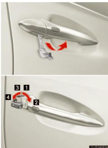
メカニカルキー（→P. 31）を使って、運転席側のカバーを取りはずしたあと操作します。
