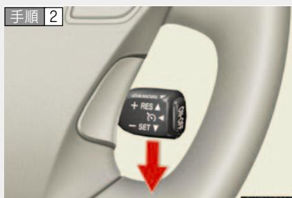
希望の速度まで加速／減速し、バーを下げるで設定する
