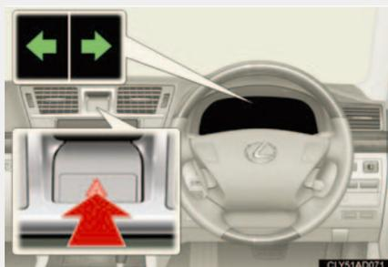
スイッチを押すとすべての方向指示灯が点滅し、もう一度押すと消灯します。
