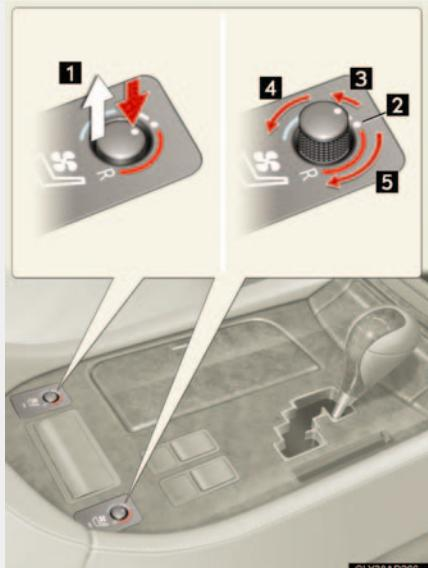
① ツマミを押し出します。左右にまわして温度を設定します。
