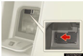
保冷機能を停止するために、冷風開閉口を閉じます。
