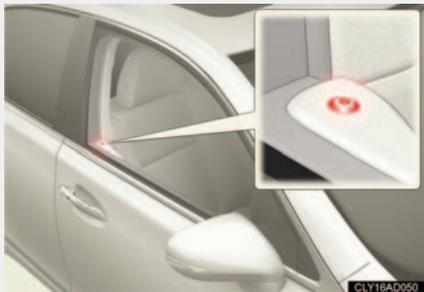
ドア・トランク・ボンネットを閉め施錠します。30秒経過すると自動的に設定されます。
