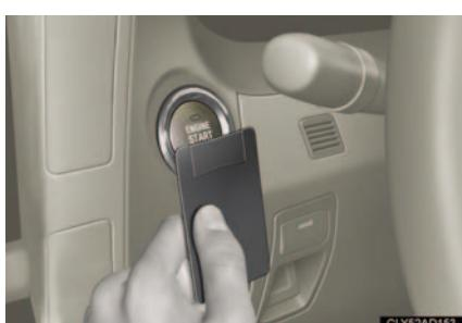
手順 [3] モードの切り替え：ブザーが鳴ってから 10 秒以内に、ブレーキペダルから足をはなして“エンジンスタートストップ”スイッチを押します。“エンジンスタートストップ”スイッチを押すごとにモードが切り替わります。( $\rightarrow$  P. 145)
