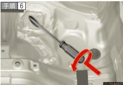
車載ドライバーのハンドルにパーキングブレーキ解除ツールを差し換える。
