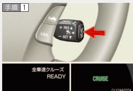
ON-OFF スイッチでシステムを ON にする
