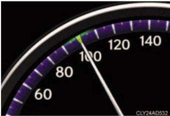
設定した車速を、インジケーターで表示します。
