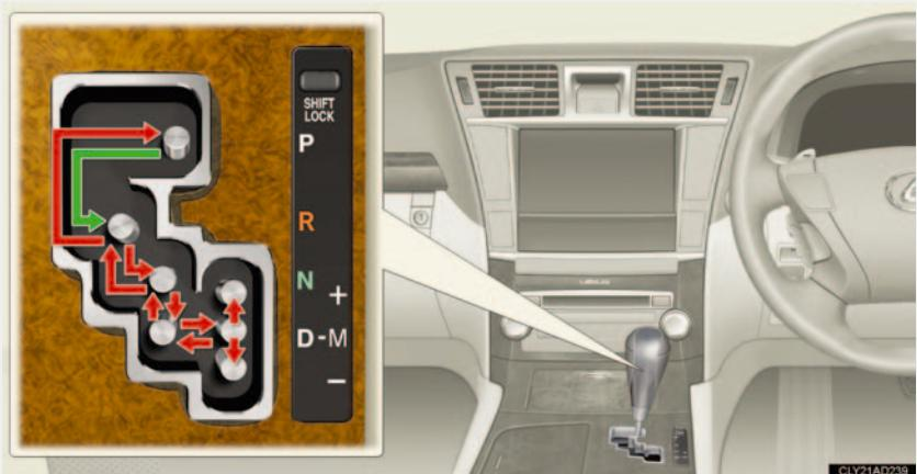
◀ “エンジンスタートストップ”スイッチがイグニッションONモードの状態で、ブレーキペダルを踏んだまま操作します。
