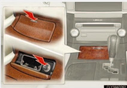
灰皿のふたを開けて、シガレットライターを押し込みます。
