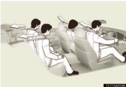
前方から強い衝突を受けたとき、シートベルトを引き込むことで適切な乗員拘束効果を確認します。
