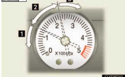
キットのスイッチを数秒間ONにし、OFFにしてから空気圧を確認する。
