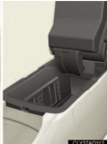
レバーを引き上げてロックを解除し、アームレストを持ち上げる。
