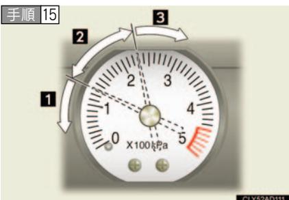
キットのスイッチを数秒間ONにし、OFF にしてから空気圧を確認する。
