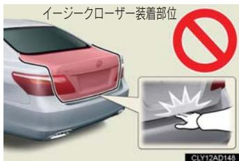
トランクが半ドア状態になったとき、イージークローザーが働き自動で完全に閉ります。また、作動し始めるまでに数秒かかります。指などをトランクの間に挟まないように注意してください。骨折など重大な傷害を受けるおそれがあり危険です。
