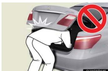
● 半開状態で使用すると、トランクリッドが落ちて重大な傷害を受けるおそれがあります。特に傾斜地では、平坦な場所よりもトランクの開閉がしにくく、急にトランクが開いたり閉じたりするおそれがあります。必ずトランクが全開で静止していることを確認して使用してください。
