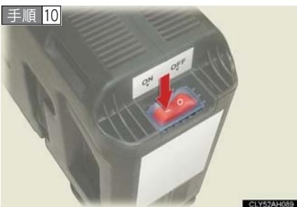
キットのスイッチを ON にし、パンク補修液と空気を充填する。
