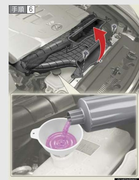
冷却水が不足している場合は、冷却水を補給する。
