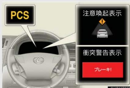
衝突の可能性があると検知したとき、注意喚起表示が出ます。さらに衝突の可能性が高い場合には、衝突警告表示出し、回避操作を促します。
