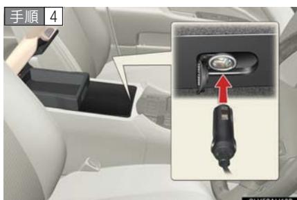
キットの電源プラグをアクセサリーソケットに差し込む。(→P. 284)
