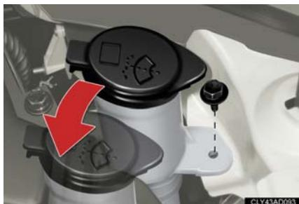
ウォツシャー液補給口の固定ボルトをはずし、補給口の位置を移動する。
