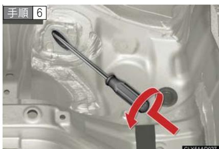
車載ドライバーのハンドルにパーキングブレーキ解除ツールを差し換える。
